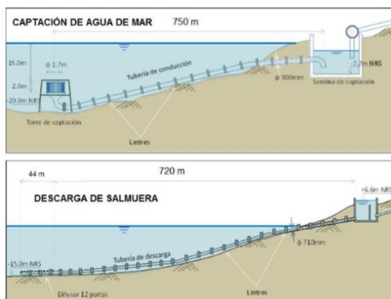
Imagen 7. Plano esquemático de proceso captación de agua de mar y descarga de salmuera.
